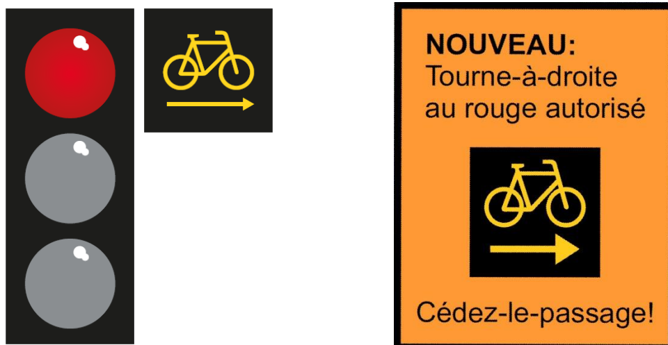
Plaquette autorisant le tourner-à-droite au feu rouge et affiche temporaire installée
